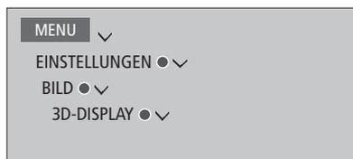
*Im Menü 3D-DISPLAY können Sie die Option 3D oder 2D auswählen und dann die **mittlere** Taste drücken, um das 3-D- oder 2-D-Fernsehen zu aktivieren oder einen Modus auszuwählen.*
